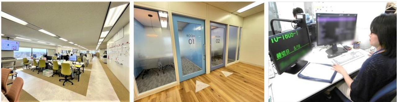
(左) 導線となる床面の色・素材を変えることで、視覚障がい者にも分かりやすい工夫をしています。 (中央) 扉はすべて引き戸になっており、会議室の扉は色や大きなサインで識別しやすくしています。 (右) 読書拡大器、画面拡大ソフト、音声認識ソフトなどの就労支援機器を導入しています。
